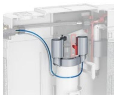
Der Aktuator für die pneumatische Betätigung wird mit nur einem Klick auf das Ablaufventil gesetzt.
