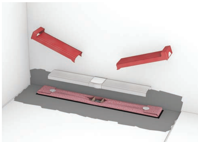
Korak 5: Nakon punjenja košuljicom uklanja se poklopac za zaštitu u fazi ugradnje i nanosi se prvi sloj zaptivnog materijala.
