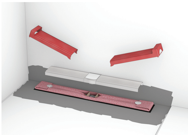
5. korak: Po vgradnji estriha se zaščitni gradbeni pokrov odstrani in vgradi prva plast kompozitne tesnilne mase.
