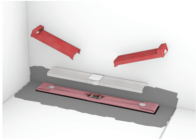
5. lépés: Az esztrichhel való feltöltés után az építési védőburkolat eltávolítható, majd a kompozit szigetelés első rétege felhordható.
