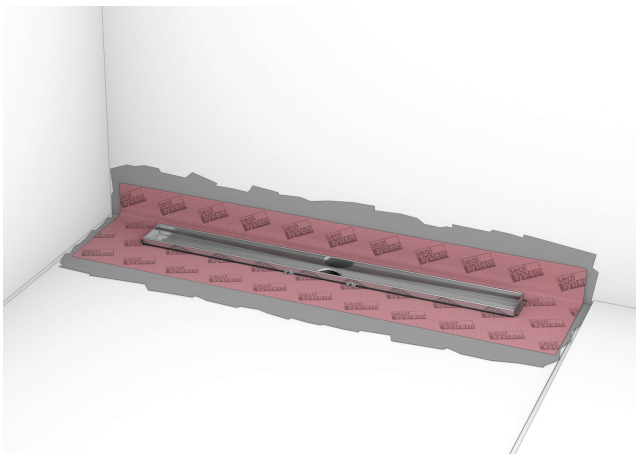
6. lépés: A szigetelőmandzsettát a kompozit szigetelésbe bele kell dolgozni.
