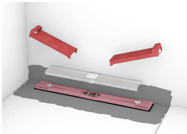
Korak 5: Nakon popunjavanja estrihom uklanja se poklopac za zaštitu u fazi gradnje te se nanosi prvi sloj brtvećeg materijala.
