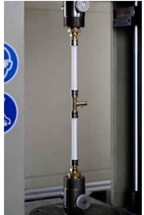
Фабрика за изведување тестови за истекување на инсталациски цевки
