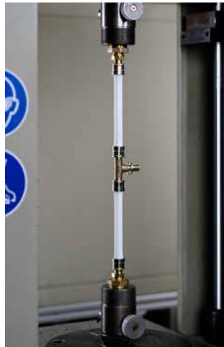
Vezetékcsőveken végzett szakítópróbák elvégzésére szolgáló berendezés
