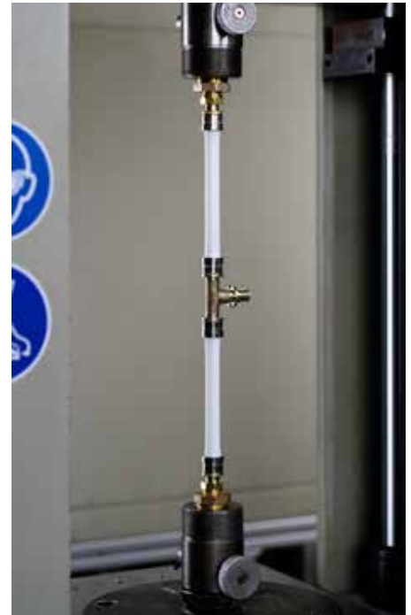
Съоръжение за провеждане на изпитвания на опън върху инсталационни тръби
