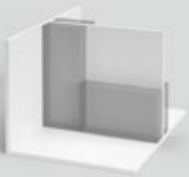
Schacht mit teilhoher Vorwand
