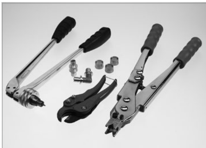
Ручні інструменти TECEflex: експандер з розширювальною головкою, труборіз, ручний затискач з вилковою насадкою (зліва направо)
