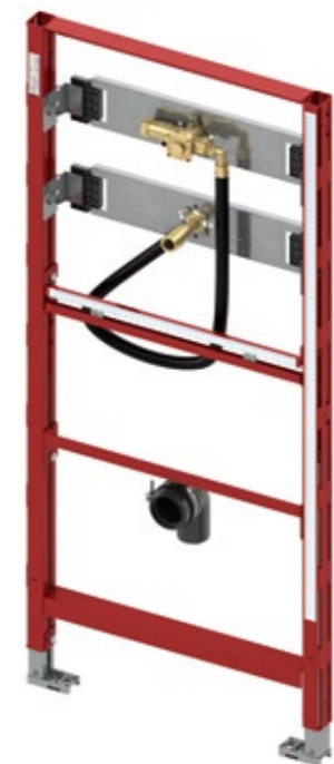
9320008 TECEprofil Módulo de urinario con elemento de descarga U 1, altura de instalación 1120 mm
