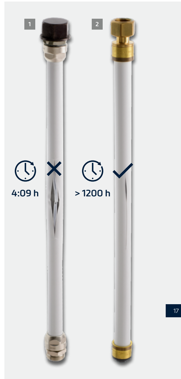
1 Standard Verbundrohr 2 TECEflex Verbundrohr
