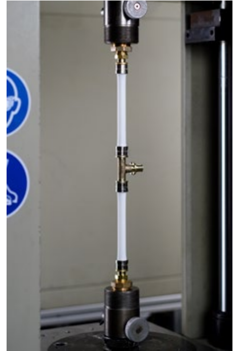
Anlage zur Durchführung von Zugversuchen an Installationsrohren
