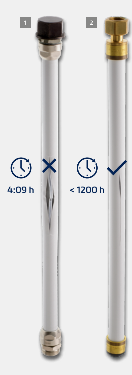
1 Standard Verbundrohr 2 TECEflex Verbundrohr
