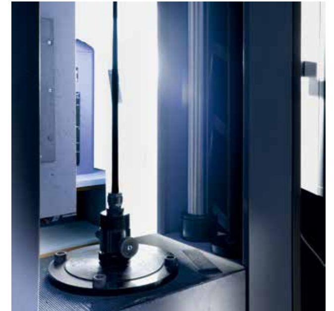
Anlage zur Durchführung von Zugversuchen an Installationsrohren
