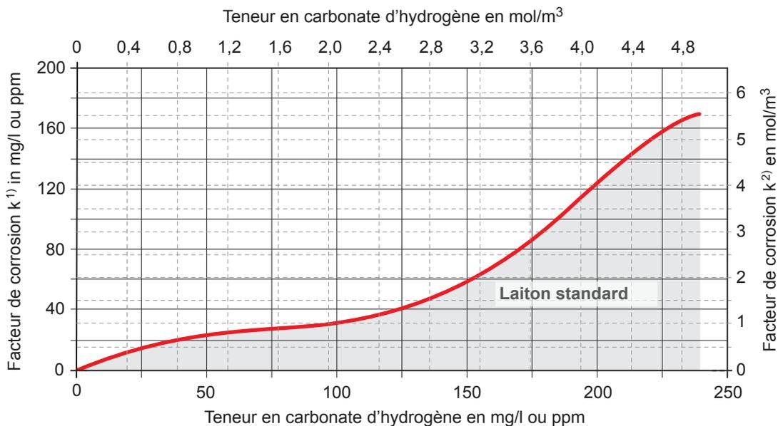
1)  $k$  = Teneur en chlorure Cl + 1/3 Teneur en sulfate  $\text{SO}_4$  (en mg/l)
