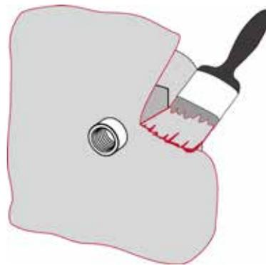
Bild 3: Aufbringen des oberen Dichtanstrichs
