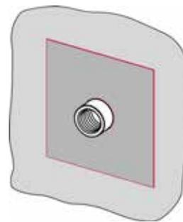
Bild 2: Dichtmanschette in noch feuchten Dichtanstrich einbetten
