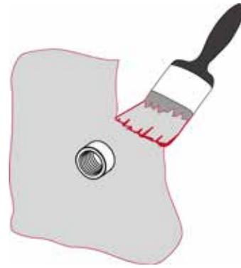
Bild 1: Aufbringen des unteren Dichtanstrichs
