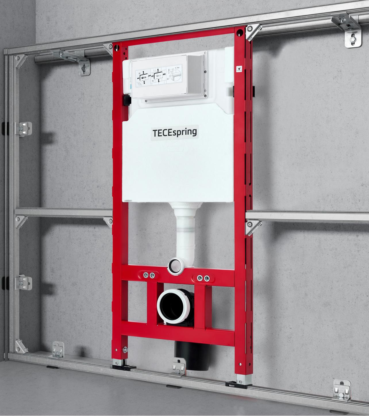
В основе всех модулей TECESpring — усиленная рама, выдерживающая нагрузку не менее 400 кг. Бачок во всех модулях оснащен системой двойного смыва с возможностью настройки. Модули TECESpring подходят для любых подвесных унитазов, но совместимы только с панелями смыва TECESpring.
