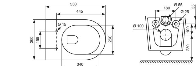
**Примечание:** Минимальная толщина обшивки стены – 20 мм.
