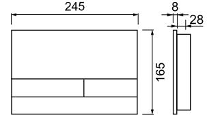
Панель смыва из стекла для унитазов с двумя режимами смыва.
