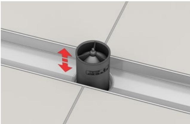
Doppelt sicher gegen Gerüche: Der nachrüstbare Membran-Geruchverschluss für TECEdrainline Abläufe sorgt zusammen mit dem Sperrwasser für einen doppelten Siphoneffekt. Er minimiert die Verdunstung des Sperrwassers durch seine Membran und schließt Ungeziefer aus – besonders geeignet für selten genutzte Duschen.
