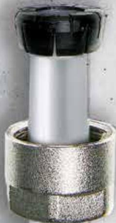
La normativa per i tubi in plastica consente un'ampia tolleranza dimensionale. Ad esempio, una "dimensione 16 x 2" può differire di pochi decimi di millimetro nel diametro interno di diversi produttori! Se ci si imbatte in accoppiamenti sfavorevoli del raccordo a stringere e del tubo, possono verificarsi perdite. Nel sistema TECEfloor, tubo e raccordo sono perfettamente coordinati.
