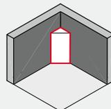
Eckaufbau 45°, teil- und raumhoch in einer Baukörperecke
