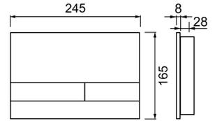
Панель смыва из стекла для унитазов с двумя режимами смыва. Две клавиши, плоский дизайн, скрытое крепление. Размеры (ш x в x г): 245 x 165 x 8 мм.
