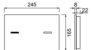
Электронная панель смыва из стекла для унитазов с бесконтактным приводом с двумя режимами смыва. Плоский дизайн, фронтальная установка. Размеры (ш x в x г): 245 x 165 x 8 мм.
