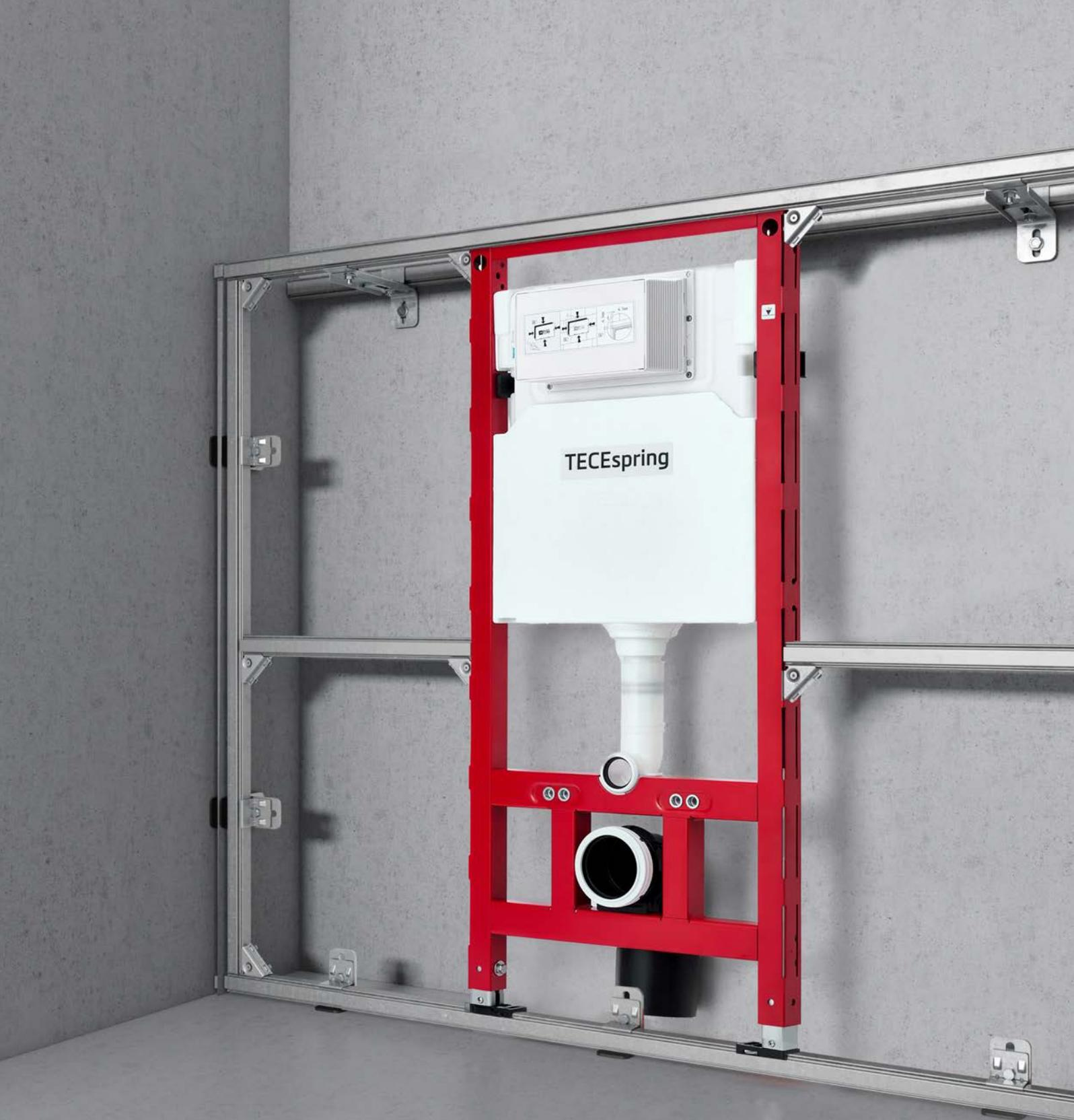
В основе всех модулей TECEspring — усиленная рама, выдерживающая нагрузку не менее 400 кг. Бачок во всех модулях оснащен системой двойного смыва с возможностью настройки. Модули TECEspring подходят для любых подвесных унитазов, но совместимы только с панелями смыва TECEspring.
