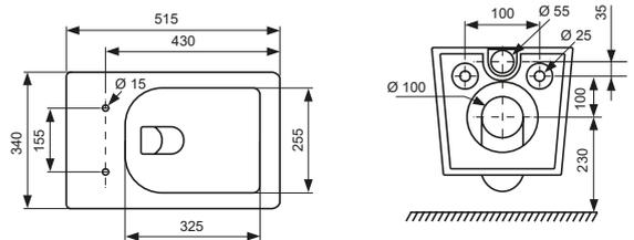
**Примечание:** Минимальная толщина обшивки стены – 20 мм.
