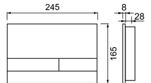
Панель смыва из акрила для унитазов с двумя режимами смыва. Две клавиши, плоский дизайн, скрытое крепление. Размеры (ш x в x г): 245 x 165 x 8 мм.
