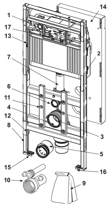
9600400 – TECElux 400 - Modulo WC con purificatore aria e regolazione della seduta, altezza di montaggio 1120 mm
