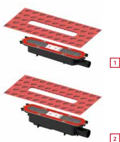
La gamma di pozzetti per le canalette doccia TECEdrainprofile è composta da uno scarico "piatto" e uno scarico "standard". Il collare di tenuta Seal System è incluso nella fornitura. Sigilla in modo sicuro con un semplice clic.
