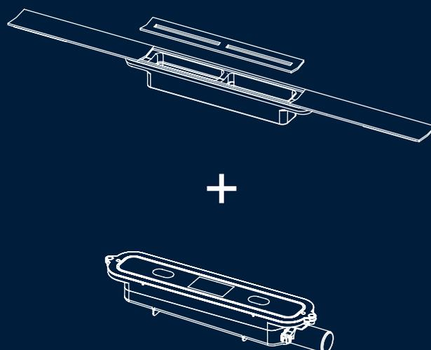
La canaletta doccia TECEdrainprofile, regolabile in lunghezza, insieme a uno dei due pozzetti disponibili, garantisce un drenaggio efficace senza necessità di ulteriori elementi. Pur essendo una gamma più essenziale, la possibilità di taglio su misura e l'installazione precisa la rendono adatta a qualsiasi configurazione della zona doccia. Realizzate in acciaio inox, le canalette sono disponibili in cinque lunghezze e cinque varianti di colore, con finiture spazzolate o lucide.
