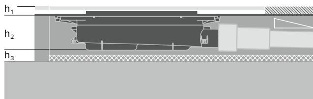
$h_1$  Altezza profilo doccia/rivestimento del pavimento da 8 a 25 mm (inclusa colla)
