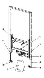
9300300 - Modulo WC con cassetta Uni, altezza di montaggio 1120 mm
