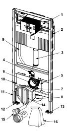
9300303 - Modulo WC con cassetta Uni, allacciamento per aspirazione odori, altezza di montaggio 1120  $\mbox{mm}$
