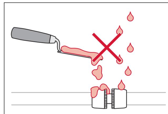
Kontakt mit korrosionsauslösenden Materialien vermeiden
