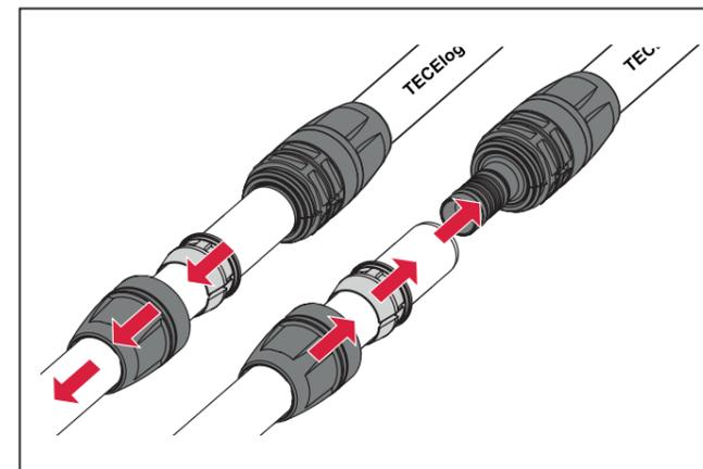
Schieben Sie nun die Schraubhülse und den Klemmring zurück und ziehen das Rohr vom Fittinggrundkörper, dann Klemmring und Schraubhülse vom Rohr. Prüfen Sie den Grundkörper vor dem Zusammenbau des Fittings und entfernen Sie ggfs. Schmutz und Späne. Bei Beschädigung des O-Rings muss dieser ausgetauscht werden.
