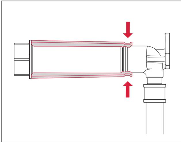
Die Dichtmanschette wird über den Stopfen gezogen und liegt direkt an der Dichthülse an.
