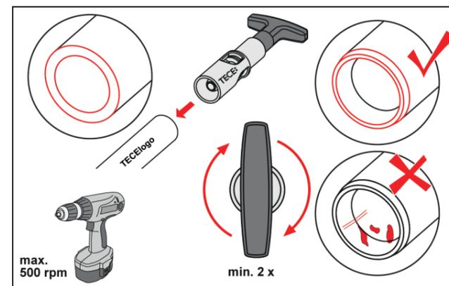
Das zur Rohrdimension passende Kalibrier- und Anfaswerkzeug (Best.-Nr. 87600xx) auf das Rohrende eines TECElogo Rohres stecken und mehrfach im Uhrzeigersinn drehen.
