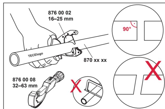
Für das Ablängen eines TECElogo Rohrs verwenden Sie bei den kleineren Dimensionen (bis 25) die TECE-Rohrschneideschere (Best.-Nr. 8760002), für die größeren bis 63 den TECE-Rohrabschneider (Best.-Nr. 8760008) Schneiden Sie die Rohre rechtwinklig ab. Verwenden Sie auf keinen Fall eine Säge o.ä. Werkzeuge!
