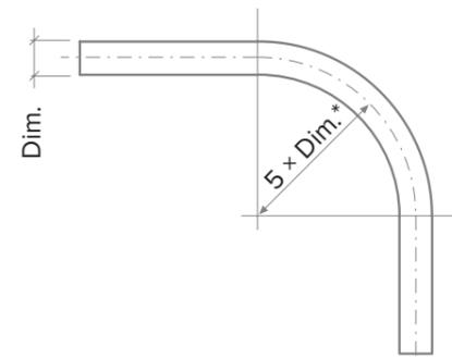
\* ohne Biegefeder, mit Biegefeder 5 x Dim.
