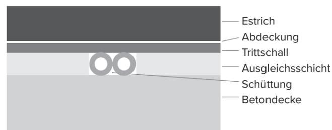
Verlegungsbeispiel für eine TECElogo Rohrleitung im Fußboden
