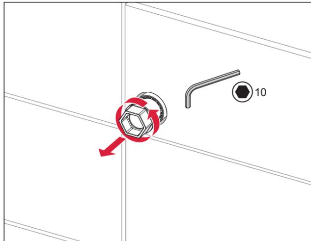
Anschließend wird die Hahnverlängerung eingedreht.
