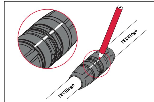
Bringen Sie vor dem Lösen eine durchgehende Markierung auf der Schraubhülse und dem Gewindeclip auf. Fixieren Sie den Fitting mit dem Demontagegabelschlüssel und schrauben Sie mit dem Demontageschlüssel die Schraubhülse ab.
