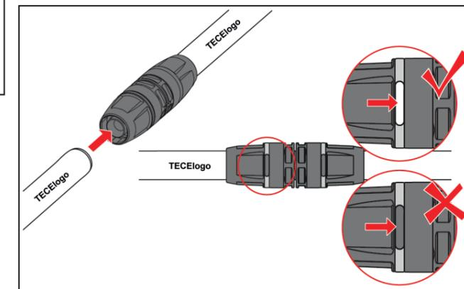
Den Fitting auf Verschmutzung prüfen, ggf. säubern oder austauschen. Entfernen Sie die Hygienekappen des Fittings erst unmittelbar vor dem Steckvorgang, um eine Verschmutzung zu vermeiden. Das TECElogo Rohr einfach bis zum Anschlag in den Fitting schieben. Die Verbindung ist erst dann korrekt abgeschlossen, wenn das Rohr in einem der Sichtfenster zu sehen ist.
