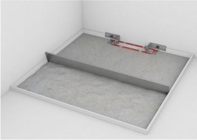
**Paso 3:** El solado debe aplicarse con una pendiente de entre un 1 y un 2 % con respecto a la pared.
