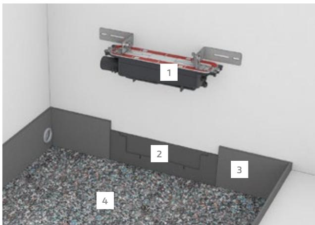
**Paso 1:** Antes de colocar el sumidero, debe prepararse la zona de ducha con destreza mediante la instalación de tiras de insonorización, tiras de aislamiento de bordes y una esterilla de insonorización a prueba de ruidos causados por impactos.
