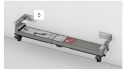
**Paso 1:** La canaleta se coloca cerrada en el lugar adecuado y se alinea. Esto se consigue fácilmente utilizando la pata de montaje opcional. El enganche en los puntos de nivelado (derecha e izquierda) simplifica la alineación de la canaleta de ducha y el nivelado del solado. La tubería de desagüe se puede colocar bajo la canaleta para ahorrar espacio.
