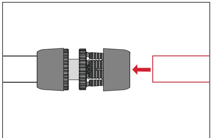
Das abgelängte Rohr darf vor dem Einstecken in den Fitting nicht angefast oder kalibriert werden. Das Rohr wird bis zum Anschlag in den Fitting geschoben. Ein gewisser zu überwindender Widerstand ist normal. Die Einstecktiefe muss vor dem Verpressen visuell geprüft werden. Dazu muss das Rohr in den Sichtfenstern der Innenhülse sichtbar sein.
