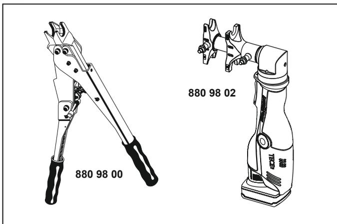
Für die Verpressung der TECElogo-Ax Fittings dürfen nur die TECElogo-Ax Systemwerkzeuge verwendet werden. Zur Auswahl stehen ein Handpresswerkzeug oder alternativ das hydraulische Akkupresswerkzeug RazFaz.
