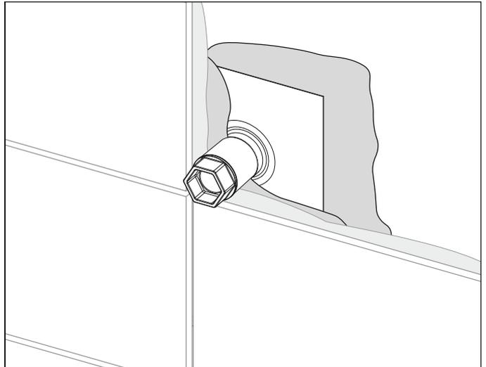
Die Dichthülse fügt sich in die Aufnahme der Schalldämmbox sicher ein.
