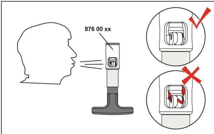
Der TECElogo-Push Kalibrierer muss frei von Schmutz sein. Nach jedem Kalibriervorgang das Kalibrier- und Anfaswerkzeug säubern („freipusten“). Zurückgebliebene Späne könnten sonst in die Dichtzone des Verbinders eingetragen werden.
