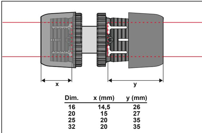
Zur Verpressung muss das Werkzeug parallel zur Rohrachse an den Fitting angesetzt werden. Die Presshülse und der Fitting müssen exakt und vollflächig anliegend im Werkzeug positioniert sein. Erst dann kann der Pressvorgang ausgelöst werden. Liegt der Fitting nicht exakt im Werkzeug, kann der Fitting bei der Verpressung geschädigt werden.
