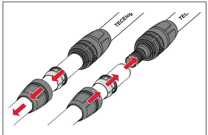
Schieben Sie nun die Schraubhülse und den Klemmring zurück und ziehen das Rohr vom Fittinggrundkörper, dann Klemmring und Schraubhülse vom Rohr. Prüfen Sie den Grundkörper vor dem Zusammenbau des Fittings und entfernen Sie ggfs. Schmutz und Späne. Bei Beschädigung des O-Rings muss dieser ausgetauscht werden.
