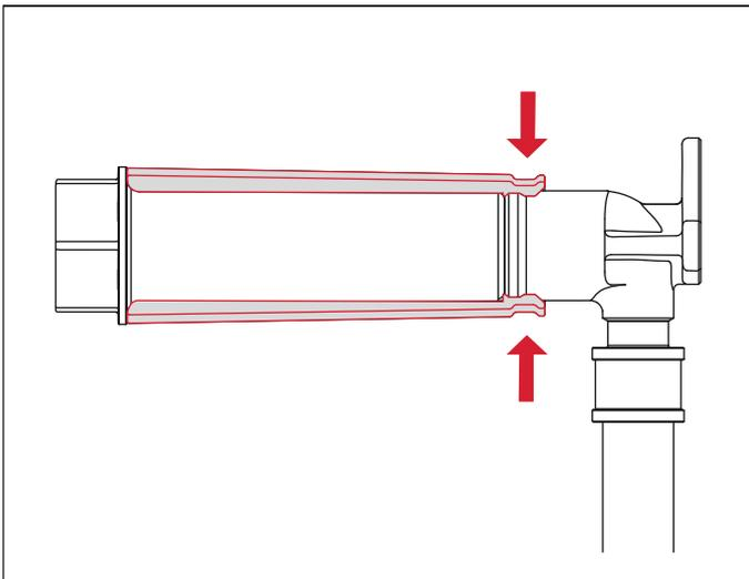
Vor der Montage der Armatur wird die Dichthülse wandbündig gekürzt und der wiederverwendbare Baustopfen herausgeschraubt.
