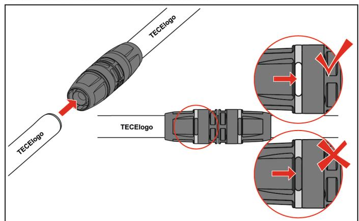
Den Fitting auf Verschmutzung prüfen, ggf. säubern oder austauschen. Entfernen Sie die Hygienekappen des Fittings erst unmittelbar vor dem Steckvorgang, um eine Verschmutzung zu vermeiden. Das TECElogo Rohr einfach bis zum Anschlag in den Fitting schieben.
