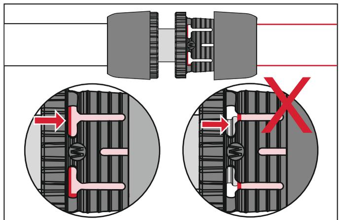
Sollte eine visuelle Prüfung der Einstecktiefe durch die örtlichen Gegebenheiten nicht möglich sein (zum Beispiel bei schlechter Beleuchtung), ist die Einstecktiefe vor dem Einstecken auf dem Rohr anzuzeichnen.
