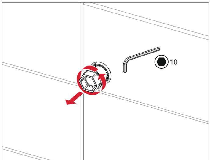
Anschließend wird die Hahnverlängerung eingedreht.
