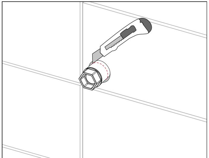
Die Dichtmanschette wird über den Stopfen gezogen und liegt direkt an der Dichthülse an.
