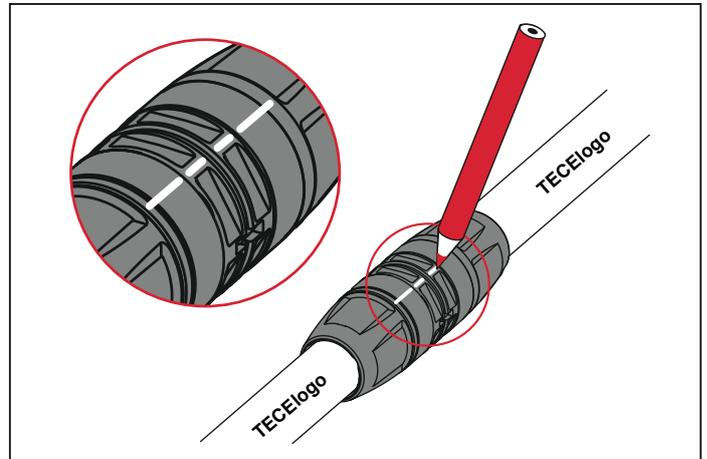
Bringen Sie vor dem Lösen eine durchgehende Markierung auf der Schraubhülse und dem Gewindeclip auf. Fixieren Sie den Fitting mit dem Demontagegabelschlüssel und schrauben Sie mit dem Demontageschlüssel die Schraubhülse ab.
