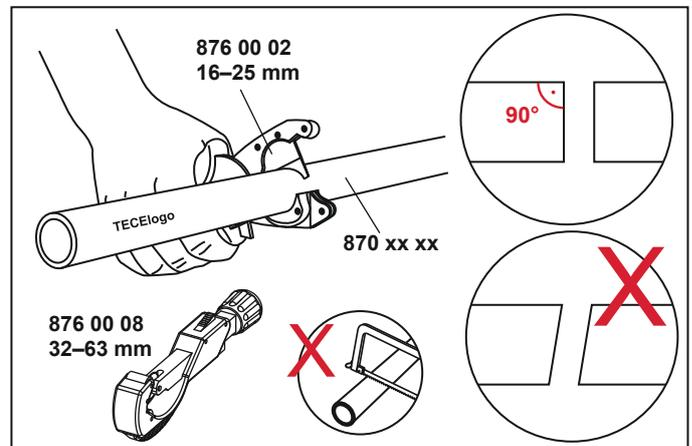
Für das Ablängen eines TECElogo Rohrs verwenden Sie bei den kleineren Dimensionen (bis 25) die TECE-Rohrschneideschere (Best.-Nr. 8760002), für die größeren bis 63 den TECE-Rohrabschneider (Best.-Nr. 8760008) Schneiden Sie die Rohre rechtwinklig ab. Verwenden Sie auf keinen Fall eine Säge o.ä. Werkzeuge!
