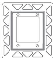
Per il montaggio a filo è **necessario utilizzare lo speciale telaio** di installazione (per WC o per orinatoio) e, nel caso di pareti in muratura, anche il **guscio grande** in polistirolo (cod. 9030029). Spessore minimo dell'intonaco 3 cm!
