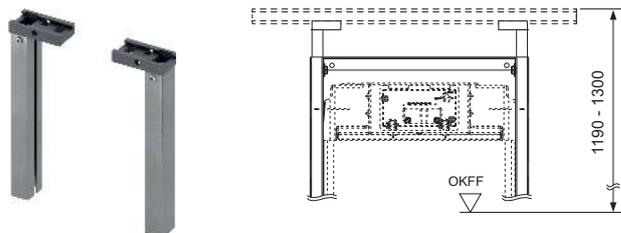
**TECE - Fissaggio per modulo, per montaggio indipendente**
