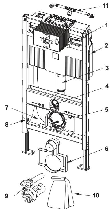
TECEprofil modulo WC con cassetta Uni, per il collegamento universale di una doccetta WC, altezza di montaggio 820 mm
