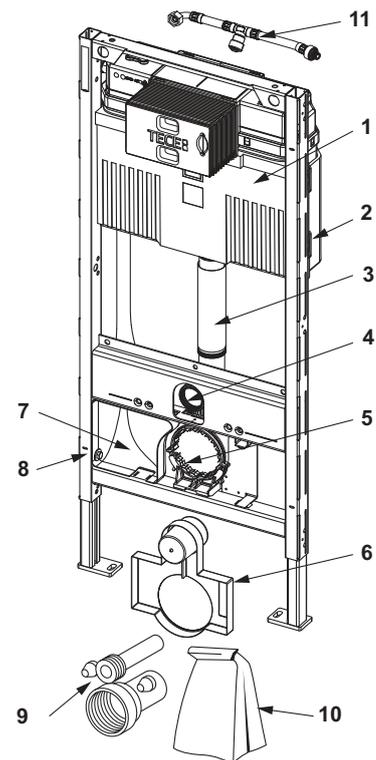
TECEprofil modulo WC con cassetta Uni, per il collegamento universale di una doccetta WC, altezza di montaggio 980 mm
