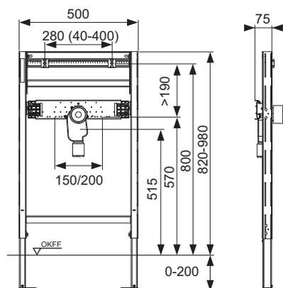
**Modulo lavabo TECEprofil per montaggio asimmetrico per scaldacqua istantaneo e lavabo, altezza di montaggio 1120 mm**
