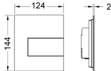
Installazione solo in combinazione con il telaio di montaggio orinatoio (cod. 9242647), da ordinare separatamente.
