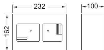
**Spessore minimo dell'intonaco 30 mm!**
