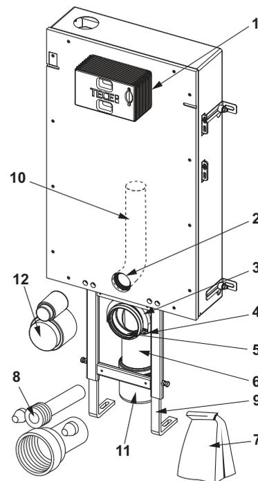
9370500 – TECEbox - Cassetta di scarico Octa II, da 8 cm, per WC a terra, con tessuto di rinforzo, altezza di montaggio 1075 mm
