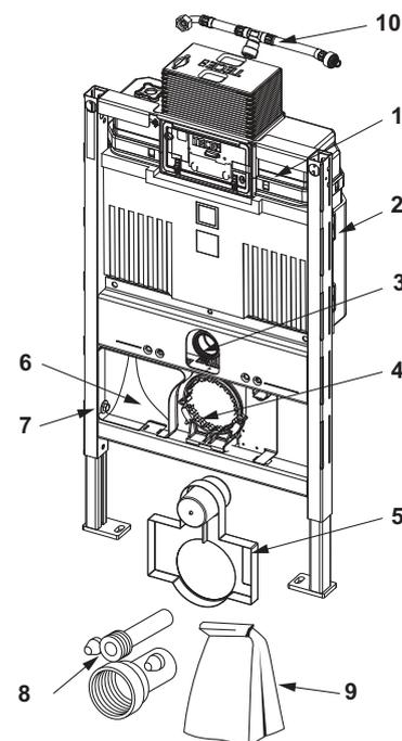
9300300 – TECEprofil - Modulo WC con cassetta Uni, altezza di montaggio 1120 mm
