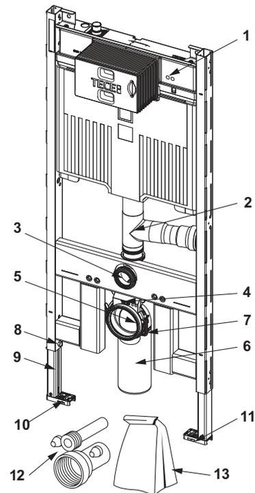
9300505 – TECEprofil - Modulo WC con cassetta Octa II, 8 cm, altezza di installazione 1120 mm
