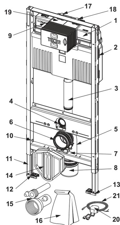
9300103 – TECEprofil - Modulo WC con cassetta Uni, con funzione di scarico igienico ad acqua fredda integrato, altezza di montaggio 1120 mm
