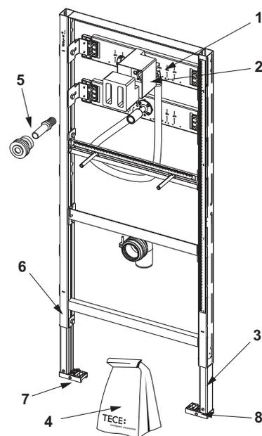
9320010 – TECEprofil - Modulo orinatoio per valvola di scarico esterna, altezza di montaggio 1120 mm
