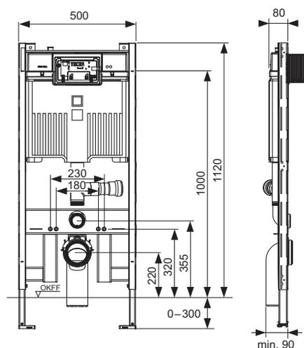
**TECEprofil - Modulo WC con cassetta Octa II, 8 cm, altezza di installazione 1120 mm**
