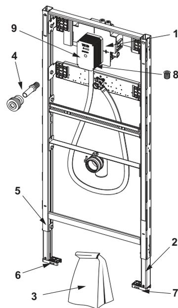
9320008 – TECEprofil - Modulo orinatoio con alloggiamento valvola di scarico TECE U 1, altezza di montaggio 1120 mm
