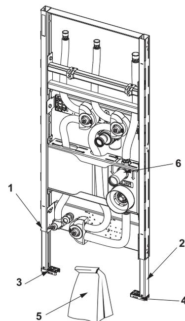
9310017 – TECEprofil modulo lavabo con due blocchi modulari per il montaggio delle capsule per la misurazione della portata idrica, altezza di montaggio 1120 mm
