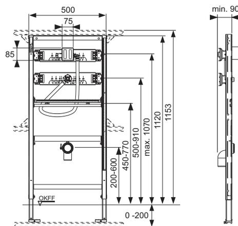
**TECEprofil - Modulo orinatoio per valvola di scarico esterna, altezza di montaggio 1120 mm**
