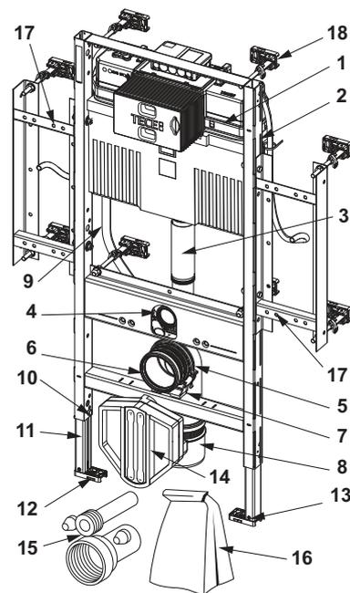
9300303 – TECEprofil - Modulo WC con cassetta Uni, allacciamento per aspirazione odori, altezza di montaggio 1120 mm
