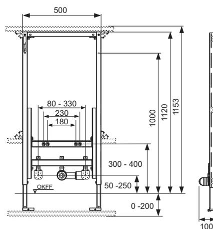
**TECEprofil - Modulo per bidet sospeso, altezza di montaggio 820 mm**
