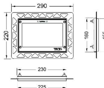
**Necessario il telaio di montaggio durante l'installazione del guscio!**
