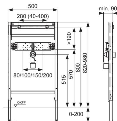
**TECEprofil - Modulo lavabo con sifone sotto intonaco, altezza di montaggio 1120 mm**
