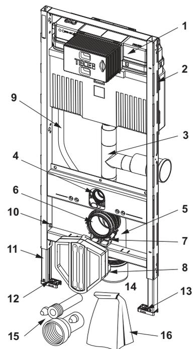
9300388 – TECEprofil - Modulo WC con cassetta Uni per WC a terra per bambini, altezza di montaggio 1120 mm
