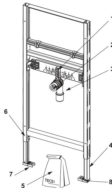
9310018 – TECEprofil - Modulo lavabo, altezza di montaggio 820-980 mm
