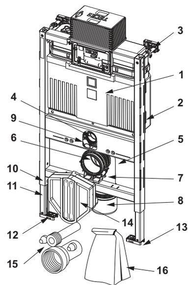
9300291 – Modulo WC TECEprofil con cassetta Uni 750, altezza di montaggio 750 mm
