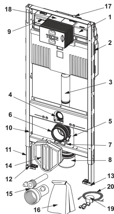
9300500 – TECEprofil - Modulo WC con cassetta Octa II, da 8 cm, altezza di montaggio 1120 mm
