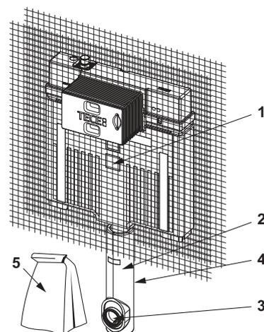
9370501 – TECEbox - Modulo WC con cassetta di scarico Octa II, da 8 cm, per WC sospeso, altezza di montaggio 1075 mm
