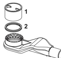
650000 – TECEdrainline - Pozzetto di drenaggio "piatto", DN 50 scarico laterale, 0,7 lt/s
