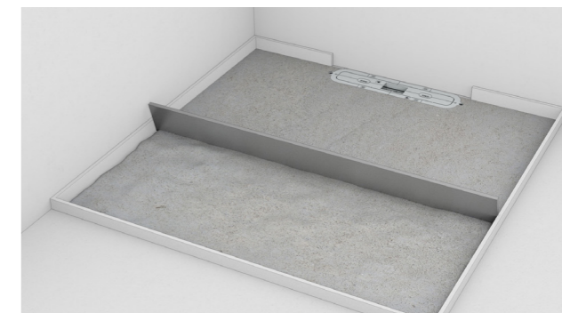
Шаг 3: Стяжка обустраивается с уклоном от 1 до 2% к стене. Чтобы защитить слив от грязи и повреждений во время монтажа, предусмотрена специальная заглушка.
