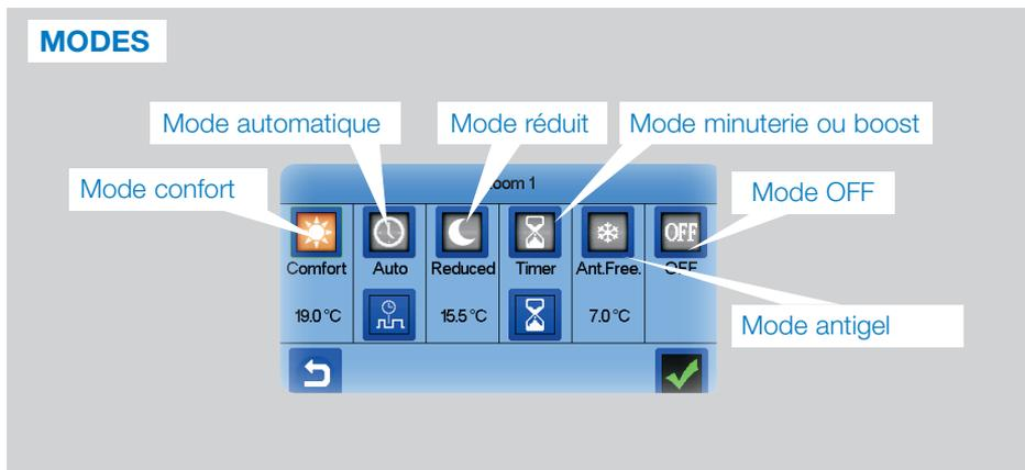
→ **Mode confort** : Réglez la pièce en mode confort. Si elle reste active, la température de confort sera suivie en permanence.
