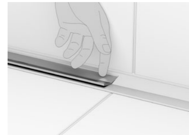
Schritt 7: Dank „Push-Funktion“ kann der Profildeckel auch im eingebauten Zustand zur Reinigung des Ablaufs werkzeuglos per Hand entnommen werden.
