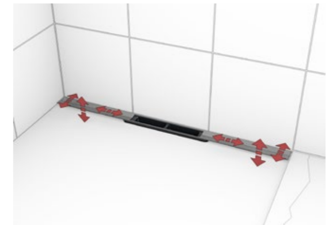
Schritt 6: Auch nach Einbringen des Ablaufs in den Estrich lässt sich das Duschprofil noch in alle horizontalen und vertikalen Richtungen feinjustieren und ist an unterschiedliche Stärken von Wand- und Bodenbelägen anpassbar.
