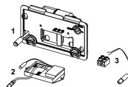
TECEplanus comando a distanza per modulo WC, per pulsante elettrico via cavo, batteria da 6V
