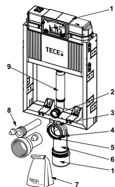
9375000 - TECEbox cassetta di scarico Uni da 13 cm e base frontale piastrellabile, altezza montaggio 820 mm
