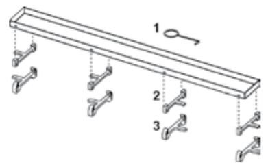
Canalina angolare TECEdrainline in acciaio inox
