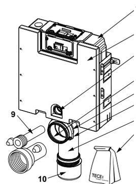
9371000 - TECEbox cassetta di scarico Uni da 13 cm e base frontale piastrellabile, altezza montaggio 1110 mm
