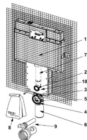
9370041 - TECEbox cassetta di scarico Octa da 8 cm con aspirazione odori, per WC sospeso Fino ad Sett. 2021
