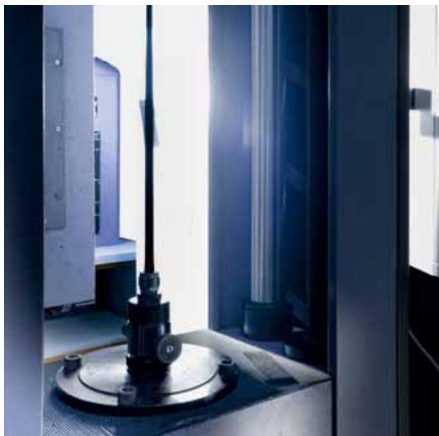
Sistema per l'esecuzione di test di trazione sui tubi di installazione.
