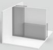
Schacht mit teilhoher Vorwand
