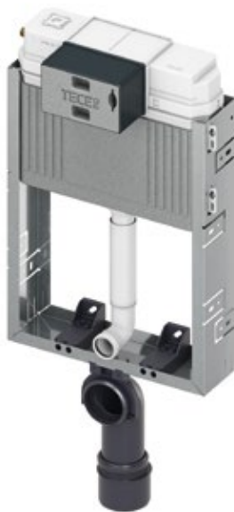
TECEbox WC-Modul mit Uni-Spülkasten, Bauhöhe 1060 mm: WC-Modul für den Einbau in eine gemauerte Vorwand vor einer Massivwand. Durch entgegengesetzte Befestigungslaschen vor oder hinter Massivwänden zu befestigen.
