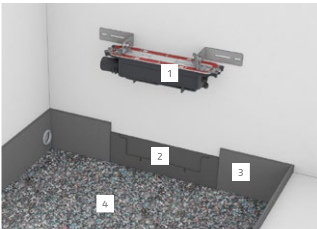
Schritt 1: Vor Einsetzen des Ablaufs wird der Duschplatz durch Einbringung des Schallschutzstreifens, des Randdämmstreifens und einer Schallschutzmatte fachgerecht vorbereitet.
