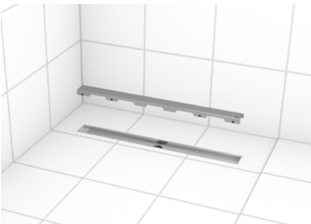
Schritt 6: Nach Verfliesen und Verfugen wird die Abdeckung in den Rinnenkörper eingesetzt. Die Montage ist damit abgeschlossen. Zur gründlichen Reinigung kann die Abdeckung auch danach jederzeit einfach entnommen und wieder eingesetzt werden.
