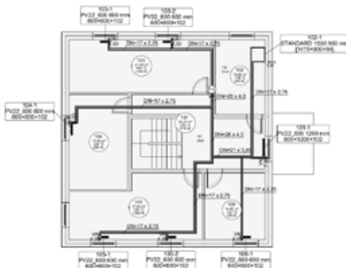
Rzut piętra - instalacja grzejnikowa
