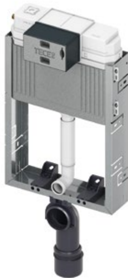
TECEbox WC-Modul mit Uni-Spülkasten, Bauhöhe 1060 mm: WC-Modul für den Einbau in eine gemauerte Vorwand vor einer Massivwand. Durch entgegengesetzte Befestigungslaschen vor oder hinter Massivwänden zu befestigen.
