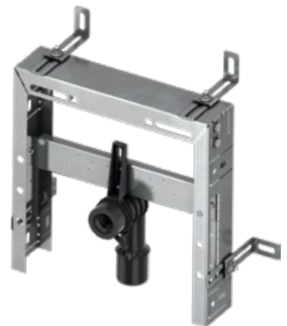
TECEbox Waschtischmodul, Bautiefe 8 cm: Zum Einmauern vor einer Massivwand. Mit vier tiefenverstellbaren Wandbefestigungen. Einbautiefe 8 bis 19 cm. Keramikbefestigungsabstand 17 bis 28 cm.
