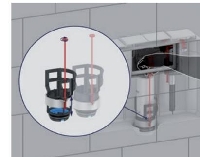
Durch Drehen der Spindel bewegt sich der Drosselring nach unten und vermindert dadurch den Spülstrom – in der untersten Stellung bleibt jedoch immer noch ein kleiner Spalt offen, sodass die Spülung nicht versehentlich komplett abgestellt werden kann.
