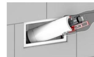
Beim Austausch des Ventils müssen keine Einzelteile auseinandergebaut oder abgenickt werden – alle Teile sind fest miteinander verbunden.
