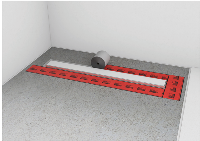
Step 3: Il nastro sigillante Seal System è incollato in modo tale da sovrapporsi tra la flangia inox della canalina e il massetto.
