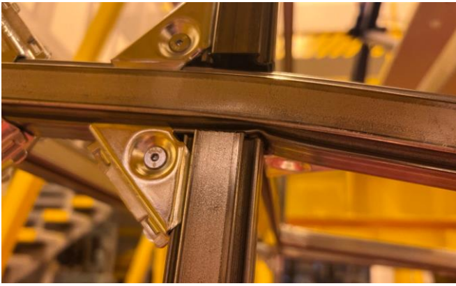
Рис. 3.53. Отработка люфтов с дальнейшей потерей местной устойчивости
