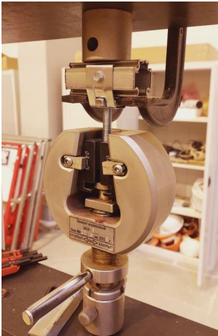
Рис. 3.23. Образец для испытания подвеса на отрыв (болт М10)
