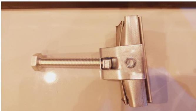
Рис. 3.26. Характер разрушения образца при испытании подвеса на отрыв
