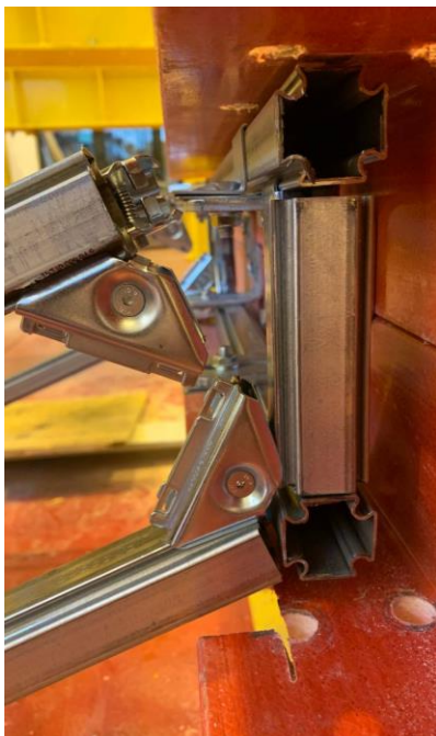
Рис. 3.41. Разкрепление цапок уголковых соединителей со стороны приложения нагрузки
