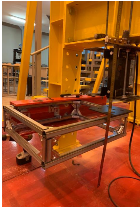
Рис. 3.39. Общий вид испытательного стенда столешницы при приложении нагрузки на угол
