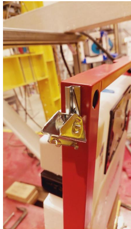
Рис. 3.47. Деформации креплений рамы бачка
