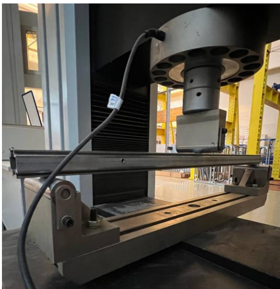
Рис. 3.13. Испытание образца на изгиб сосредоточенной нагрузкой (длина 70см)
