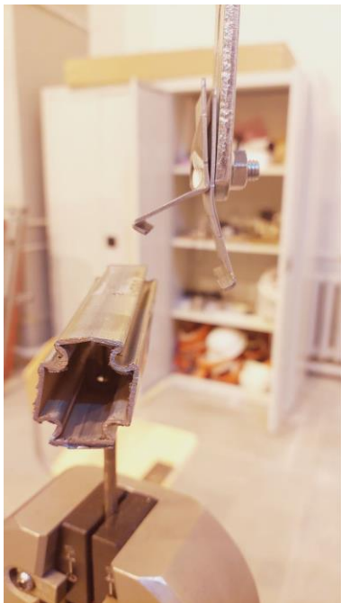
Рис. 3.32. Раскрепление зажима вследствие потери местной устойчивости профиля
