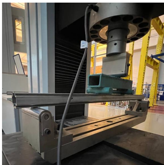
Рис. 3.14. Испытание образца на чистый изгиб (длина 70см)
