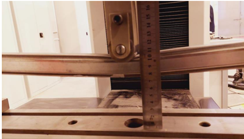
Рис. 3.18. Замеры прогиба образца длиной 100см при испытаниях на изгиб
