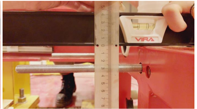
Рис. 3.48. Замеры прогибов шпилек и оценка их деформаций после приложения нагрузки
