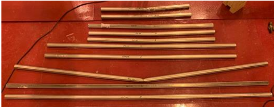
Рис. 3.19. Замеры прогиба образца длиной 100см при испытаниях на изгиб
