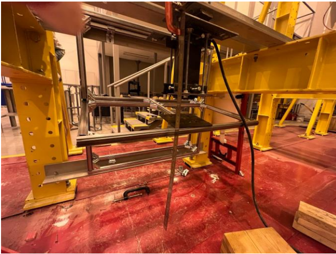
Рис. 3.49. Общий вид испытательного стенда конструкции под лежак при загрузке по середине пролета
