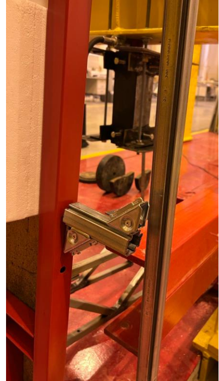
Рис. 3.45. Раскрепление цапок уголковых соединителей
