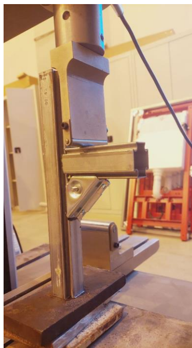
Рис. 3.21. Образец узла уголкового соединителя при испытании на сползание до испытания
