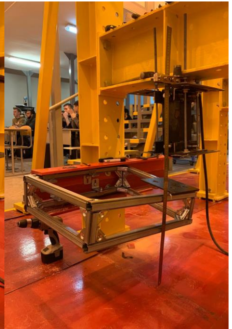
Рис. 3.40. Остаточные прогибы столешницы при приложении нагрузки на угол
