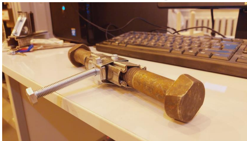
Рис. 3.26. Характер разрушения образца при испытании подвеса на отрыв
