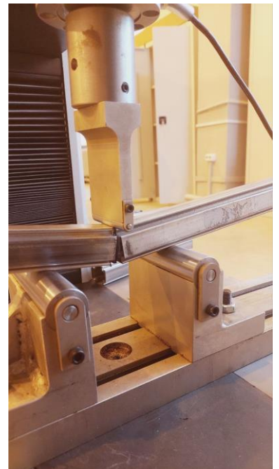
Рис. 3.34. Раскрытие соединения по растянутой зоне
