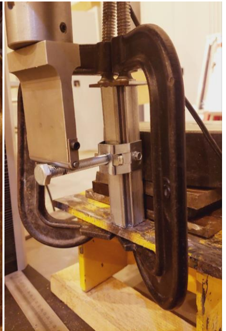
Рис. 3.25. Образец для испытания подвеса на срез вдоль стержня профиля
