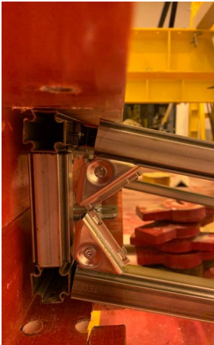
Рис. 3.38. Разкрепление цапок уголковых соединителей с обеих сторон конструкции столешницы
