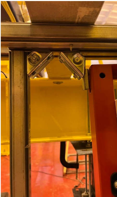
Рис. 3.46. Выход из цапок углового соединителя креплений рамы бачка
