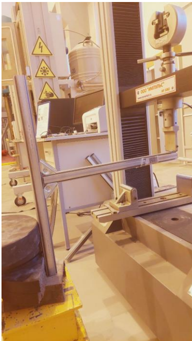
Рис. 3.20. Образец узла уголкового соединителя при испытании консоли
