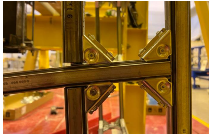
Рис. 3.55. Остаточные прогибы консоли при приложении нагрузки на угол
