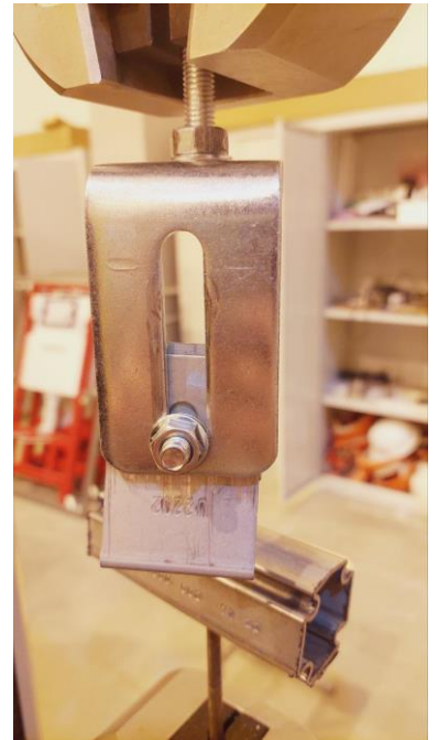
Рис. 3.31. Деформации в настенном крепеже от сползания зажима
