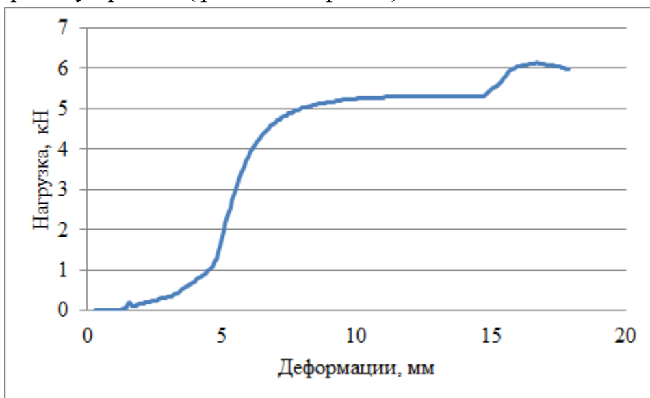
Рис. 4.6. Диаграмма деформирования образца, испытанного на изгиб
