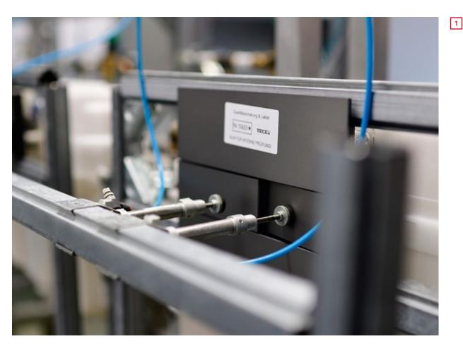
El mecanismo de activación de las placas de accionamiento se somete a una prueba de fatiga de 200 000 ciclos y, después de esta, debe permanecer totalmente operativo.
