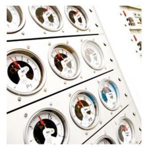
En el laboratorio de pruebas de sistemas de tuberías, los puntos de la curva estándar se observan y monitorizan. Por ejemplo, se mide la vida útil de una muestra de una tubería a 90 °C y 10 bares y, posteriormente, se registra.
