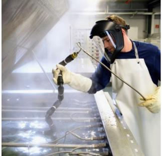
Se examina un «árbol de prueba» con diferentes puntos de conexión surmergidos en agua a 90 °C y a 10 bares para comprobar si existen fugas. De este modo se identifican rápidamente las fugas presentes en componentes defectuosos.
