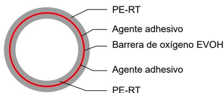
Clasificación según la norma DIN EN ISO 22391-2, clases de aplicación 4 y 5: 6 bar, 90°C temp máx.
