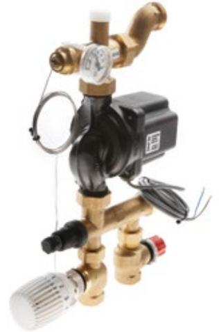
Para armonizar hidráulicamente la calefacción de suelo conectada con el resto de la instalación de calefacción, el regulador de valor fijo TECEfloor está equipado con una válvula de control (1) en el retorno primario y una válvula de compensación (3) en el retorno del circuito de calefacción de suelo.
