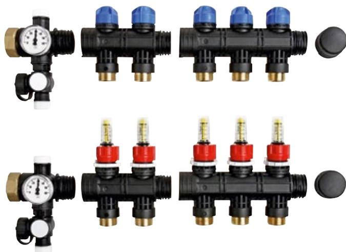
El volumen de agua se regula a través de las válvulas reguladoras de caudal bloqueables con caudalímetro integrado de 0-3,5 l/min. Los caudalímetros disponen de un anillo de bloqueo según la norma DIN EN 1264-4, que permite el equilibrado hidráulico interno. Las mirillas se pueden sustituir con bajo presión o incluso retirarse para la limpieza.
