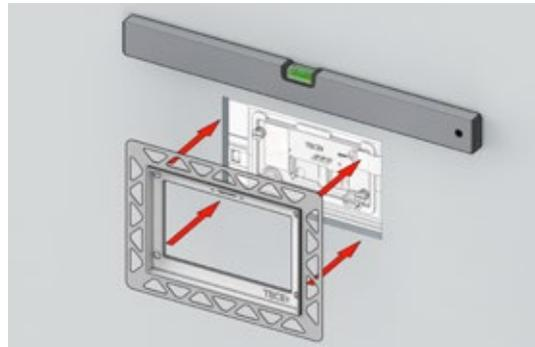
Der Einbaurahmen wird inklusive Stützrahmen mithilfe von werkseitig angebrachten Klebestellen auf dem Putz bzw. der Gipskartonplatte fixiert.
