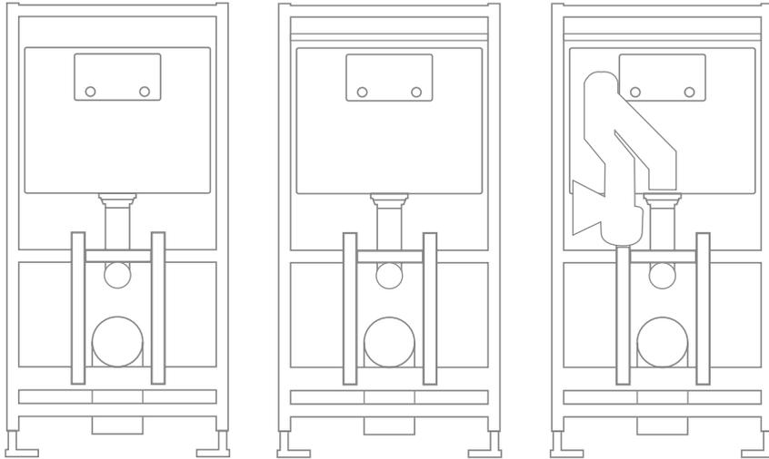
Obere WC-Betätigungsplatten mit unterschiedlichen Auslösevarianten
