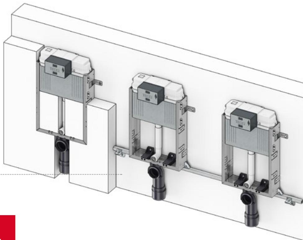
**Alle Nassbau-WC-Module erfüllen den Standard-Schallschutz nach DIN 4109/A1.**
