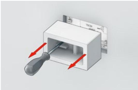
Nach Verputzen (Nassbau) oder Befestigung der Gipskartonplatte (Trockenbau) wird der jeweilige Rohbauschutz entfernt.
