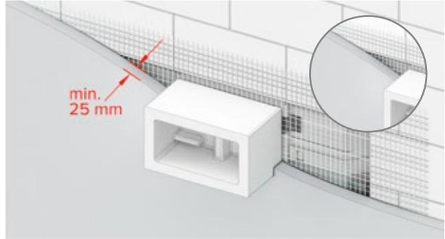
Für die flächenbündige Montage im Nassbau wird der Standard-Rohbauschutz des Spülkastens gegen den Nassbau-Rohbauschutz ausgetauscht. Nach Verputzen auf einem geeigneten Untergrund (Streckmetall, Armierungsgewebe o. Ä.) kann der Nassbau-Rohbauschutz wieder demontiert werden.
