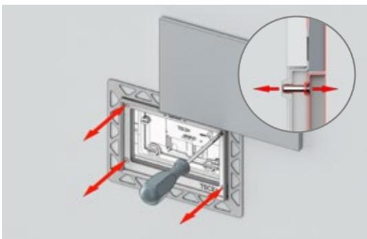
Die Tiefe des Einbaurahmens kann entsprechend der Fliesenstärke (5–18 mm) eingestellt werden. Für einen stärkeren Wandaufbau (bis 33 mm) ist ein zusätzliches Aufrüstset erhältlich.
