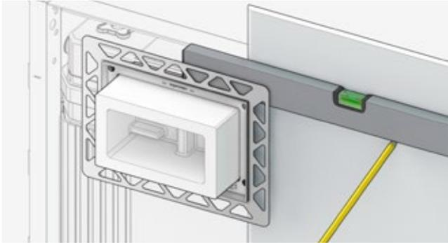
Zur Aussparung der Gipskartonplatte für die Revisionsöffnung des Spülkastens wird der Einbaurahmen über den Styropor-Rohbauschutz gesteckt. Für den Zuschnitt der Gipskartonplatte werden die Maße des inneren Einbaurahmens abgenommen.
