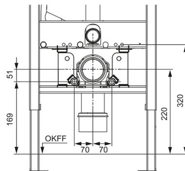
**Kit de montage TECEone pour module WC avec réservoir de 8 cm**
