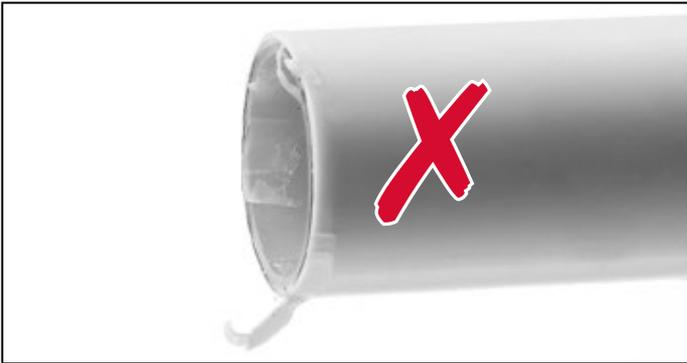
Tubo calibrado incorrectamente
