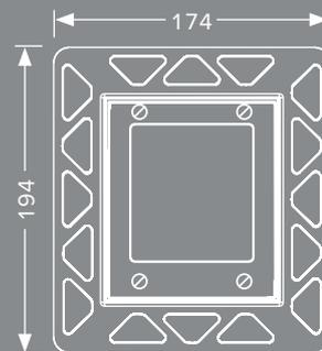
Marco de montaje para instalar la placa de accionamiento de urinario empotrada.
