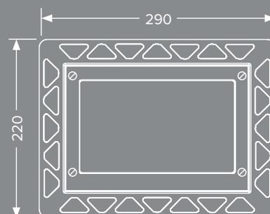
Las placas de accionamiento TECEvelvet pueden instalarse totalmente a ras de la pared mediante un marco de montaje especial.
