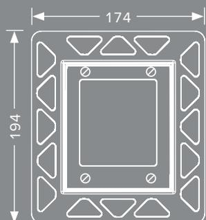
Marco de montaje para instalar la placa de accionamiento de urinario empotrada.
