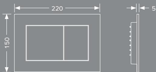
TECEnow es una placa de accionamiento de WC de plástico para las cisternas de TECE, con posibilidad de accionamiento frontal o superior.
