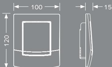
Placa de accionamiento de urinario TECEambia fabricada de plástico con cartucho de válvula de descarga para la carcasa de válvula de descarga U1. Dimensiones: 100 x 120 x 15 mm
