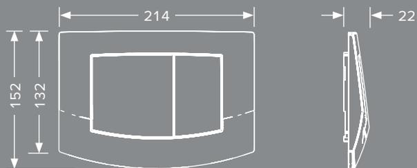
La placa de accionamiento para WC de plástico puede utilizarse para un accionamiento frontal o superior. Los amortiguadores de goma situados a ambos lados permiten eliminar de manera fiable los ruidos mecánicos durante los accionamientos.
