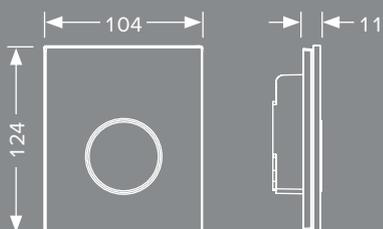
Placa de accionamiento TECEloop fabricada de cristal con cartucho de válvula de descarga para la carcasa de válvula de descarga U1.
