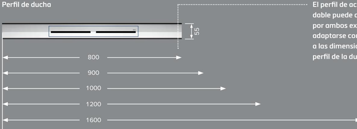
El perfil de acero inoxidable puede acortarse por ambos extremos y adaptarse con precisión a las dimensiones del perfil de la ducha.
