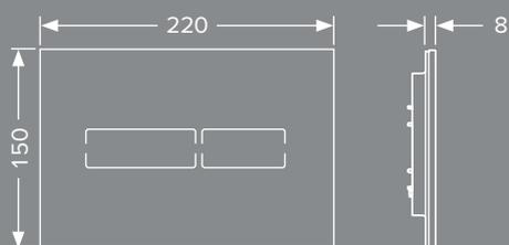
La placa de accionamiento plana de cristal de seguridad se instala prácticamente al mismo nivel que la pared.
