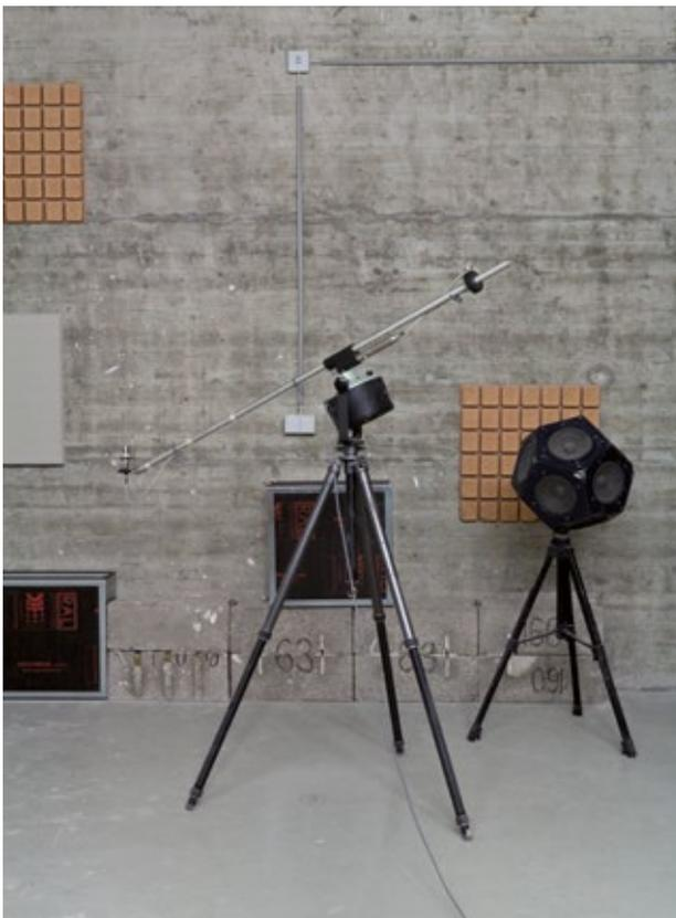
Schallschutzprüfung einer TECE Sanitärwand beim Fraunhofer-Institut für Bauphysik. Sinnvoll ist ein geringer Geräuschpegel im Hotel – aber auch im privaten Wohnungsbau. Für geringe Geräuschpegel werden beim TECEprofil System spezielle Schallschutzelemente verwendet. Unabhängige Gutachten bestätigen die verringerte Übertragung von Schallwellen in den Baukörper.
