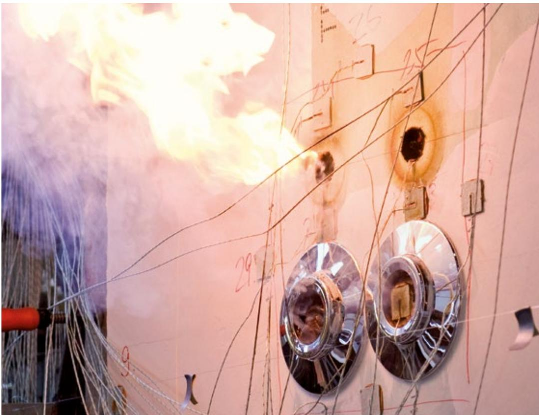
Brandschutzprüfung an der Materialprüfanstalt für das Bauwesen in Braunschweig. Je nach Ausführung der Sanitärwand wurden bei einseitiger Brandbeanspruchung Feuerwiderstandsklassen bis F 120 erreicht.
