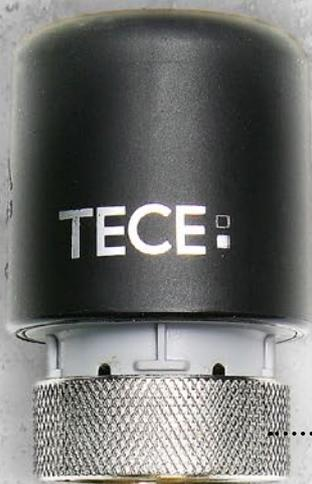
Algunos colectores disponibles en el mercado tienen roscas muy afiladas. Con una conexión roscada de plástico, una rosca nueva puede cortarse rápidamente y el accionamiento quedará mal asentado. En este caso, la tuerca de unión metálica ofrece una protección fiable.
