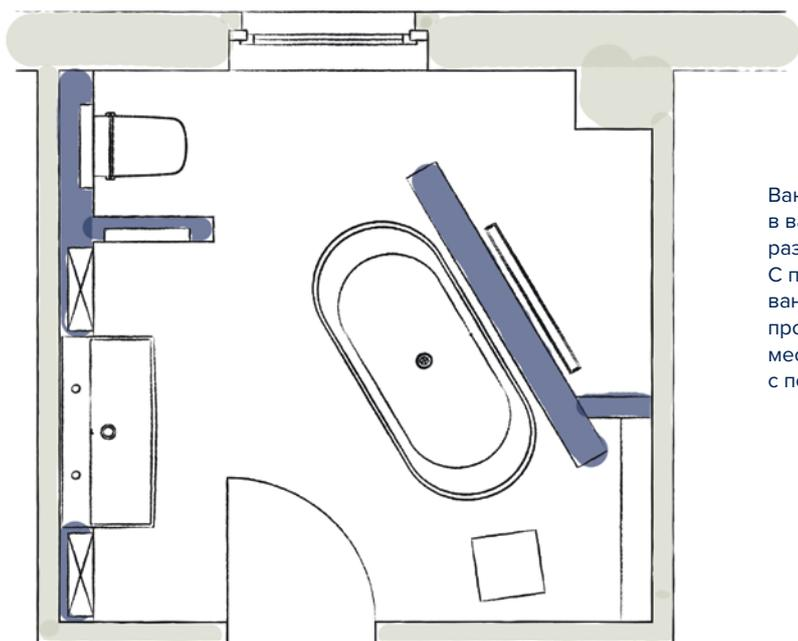
Ванна занимает много пространства в ванной комнате, но не всегда обязательно размещать оборудование вдоль стены. С помощью застенных систем установка ванны в центре комнаты больше не является проблемой и оставляет также достаточно места для устройства душевой зоны вровень с полом.
